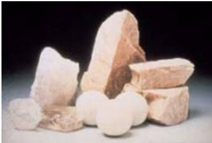
Drei Mal Werkstoff: Hier Rosenquarz, Siliziumoxid und Kaolin-Grundmaterial des keramischen Zahns. (Foto: IVOCLAR)
